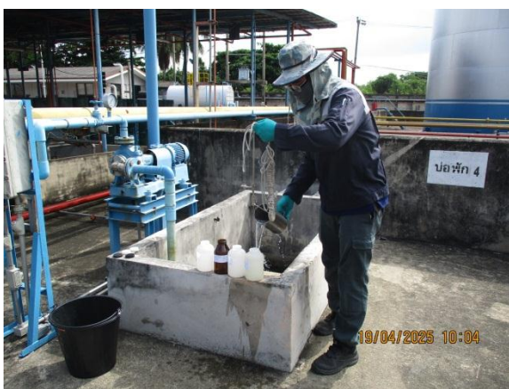
รูปที่ 3.2.1-3 วิธีการเก็บตัวอย่างน้ำทิ้งจากบ่อบำบัดหมายเลข 4
