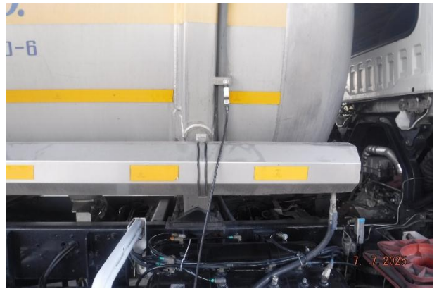
รูปที่ 2.2.2-3 จุดต่อสายกราวด์ตัวรถ Bulk
